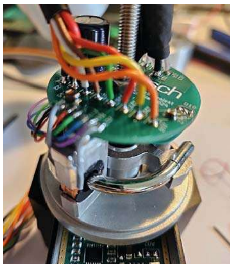
Tonarmdetail: Freier Blick auf einen Teil der Elektronik im Tonarm (unten), den Antiskatingaktor, ausgeführt als bogenförmiger „Linear“-Motor (Mitte) und die Anschlussplatine mit den Leitungen für die Schwebelagersteuerung im Vordergrund.
