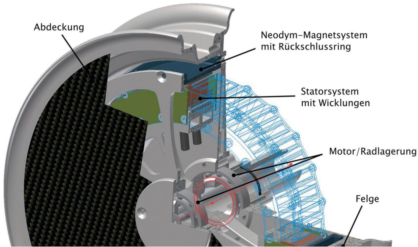
CAD-SCHNITTMODELL (REDUZIERT) EINES RADNABENDIREKTANTRIEBS DES AUTORS
